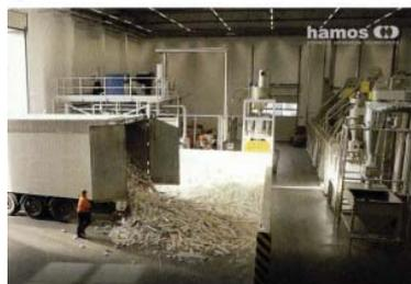
Aufbereitung von Altfenstern und Abschnitten mit Hilfe der hamos-Separationstechnik.
