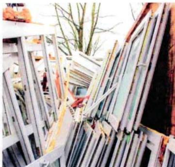
Alte PVC-Fenster können auch mit Glas und Beschlägen dem Recycling zugeführt und alle Materialien separiert sowie wiederverwertet werden. Foto: Rewindo
